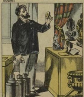
Lorsque l'on jette suffisamment l'épaisseur du dépôt métallique sur une pile, celle-ci le met dans le bain, on le décale, et on trouve, en cette partie une croix, une planche gravée, un cliché typographique, etc. absolument identiques au type primitif, et qui ne doivent leur origine, qu'à l'action de l'électricité. La galvanoplastie est aujourd'hui une des nos plus grandes industries.
