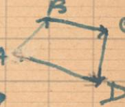
On trouvera la résultante de 3 vecteurs quelconques en traçant des vecteurs équivalents aux vecteurs donnés et placés bout à bout, et en cherchant la résultante de ces derniers.
