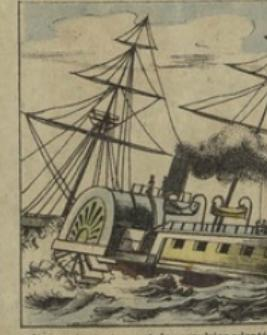
Le premier instrument de propulsion adopté pour les navires à vapeur, a été la *ROUE à AUBES*, formée de palettes de fer remplaçant les rames et pouvant tourner autour d'un axe de façon à plonger tout à tour d'une certaine profondeur dans la mer.
