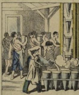
Le MOULAGE, ou mise en forme, s'opère en versant la masse cuite dans des vases de bâle vernie ayant la forme d'un pain de sucre renversé; la masse cuite versée bouillante se refroidit pendant 24 heures environ.
