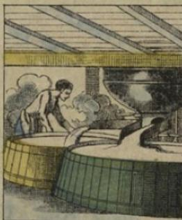
Le sirop, à la sortie des filtres, est envoyé aux APPAREILS à CUIRE où l'eau s'évapore et les cristaux de sucre se forment. La masse qui se met à cuire tombe dans de grandes cuves appelées RÉCHAUFFEURS, d'où des tuyaux la distribuent aux ateliers de moulage.
