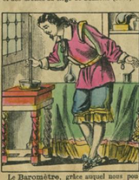
Le **Baromètre**, grâce auquel nous pouvons apprécier la variation de la pression de l'air, a été inventé en 1643, par Torricelli, disciple de Galilée. Le baromètre sert aussi à constater les hautesurs auxquelles on se trouve, par suite de l'abaissement de la colonne de mercure au fur et à mesure qu'on s'élève dans l'atmosphère.
