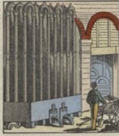
Cette opération est suivie d'un lavage à l'eau dans une colonne de coke qui retient les sels ammoniacaux. L'opération chimique complète se travaille mécaniquement en enlevant au gaz l'ammonium, l'acide carbonique et l'hydrogène sulfure.
