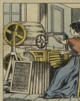
On fabrique également des ALLUMETTES-BOUGIES. Dans ce cas, les petites bâchettes de bois sont remplacées par des bouts de tresse de coton sans fin, que l'on fait passer dans un bain de cire fondu, en qu'une machine spéciale coupe en bouts de 5 centimètres.
