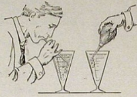
Fig. 2. L'air expiré trouble l'eau de chaux : il contient du gaz carbonique.
