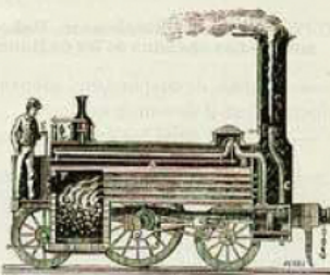
LA LOCOMOTIVE MODERNE, DUE À STEPHENSON ET À SON FILS. — F. figure un bras le charbon de terre. A, chaudière renfermant un grand nombre de tubes (a) à travers lesquels passe la fumée, soulevée dans un réservoir d'eau, pour mieux chauffer l'eau. — L'invention de cette chaudière, sans laquelle on ne pourrait atteindre une grande vitesse, a été la pierre de Sévigné, qui inventa la locomotive presque au même temps que Stephenson. — B c, conduits par lesquels la vapeur arrive sur le piston, placé en bas, à droite, qui fait marcher les roues.
