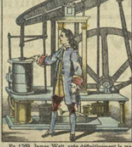
En 1765, James Watt créa définitivement la machine à vapeur telle que nous la connaissons. Au lieu d'employer le vide et la pression de l'air, il employa la vapeur comme moteur sur les DEUX FACES du piston : il inventa le condenseur, la pompe à air, le régulateur, le parallélogramme articulé, etc. etc.
