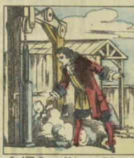
En 1672, Huyghens fabriqua un cylindre muni d'un piston sous lequel il faisait détoner de la poudre à canon. Le piston s'élevait brusquement : on formait le vide au-dessous de lui, et alors, chaussé d'une cuirasse contre l'air, le piston redescendait dans le cylindre entraînant après lui des poids ou l'eau d'un puissant.
