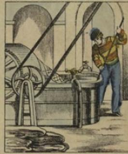
Lorsque la chaux a consommé toute la laine des chiffons et qu'il ne reste plus que le coton et le fil, les seules matières qui peuvent faire du papier, on passe les chiffons dans les PILES BROYEUSES qui réduisent la matière en une épaisse bouillie que l'on blanchit avec du chlore.
