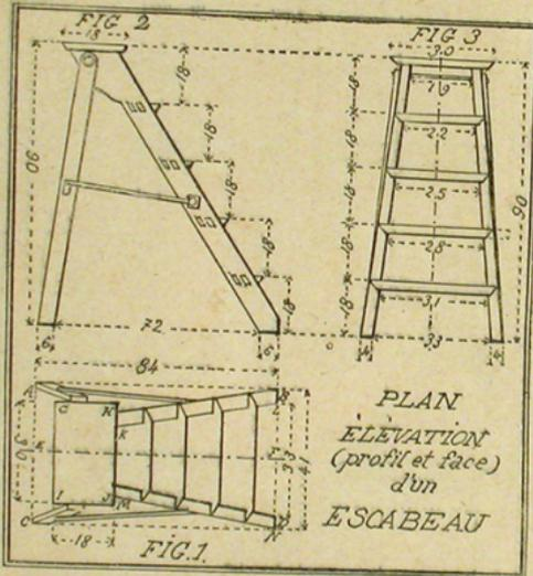
ÉLEVATION DE PROFIL (fig. 2). — Prolonger, par des lignes de rappel, toutes les lignes verticales du plan. Déterminer la hauteur du modèle et dessiner les deux montants. Les assemblages des marches seront visibles. Dessiner à sa place le crochet d'arrêt.
