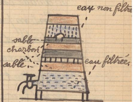
L'eau se filtre en passant à travers des couches de sable et de charbon C; une éponge la laisse passer lentement à travers les trous de la pomme d'arrosoir.
