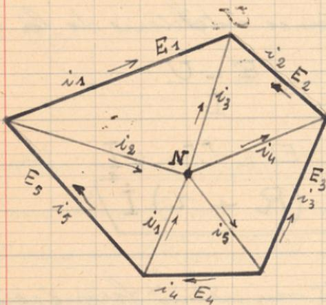
$$(R_1 i_1 - E_1) - (R_2 i_2 - E_2) - (R_3 i_3 - E_3) + (R_4 i_4 - E_4) - (R_5 i_5 - E_5)$$
