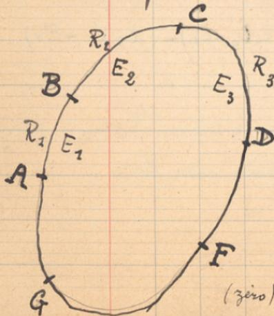
Soit un circuit fermé contenant un certain nombre de récepteurs et de générateurs. Divisons le circuit en portions ne contenant qu'un récepteur ou qu'un générateur. Dans la 1<sup>re</sup> portion on peut écrire :
