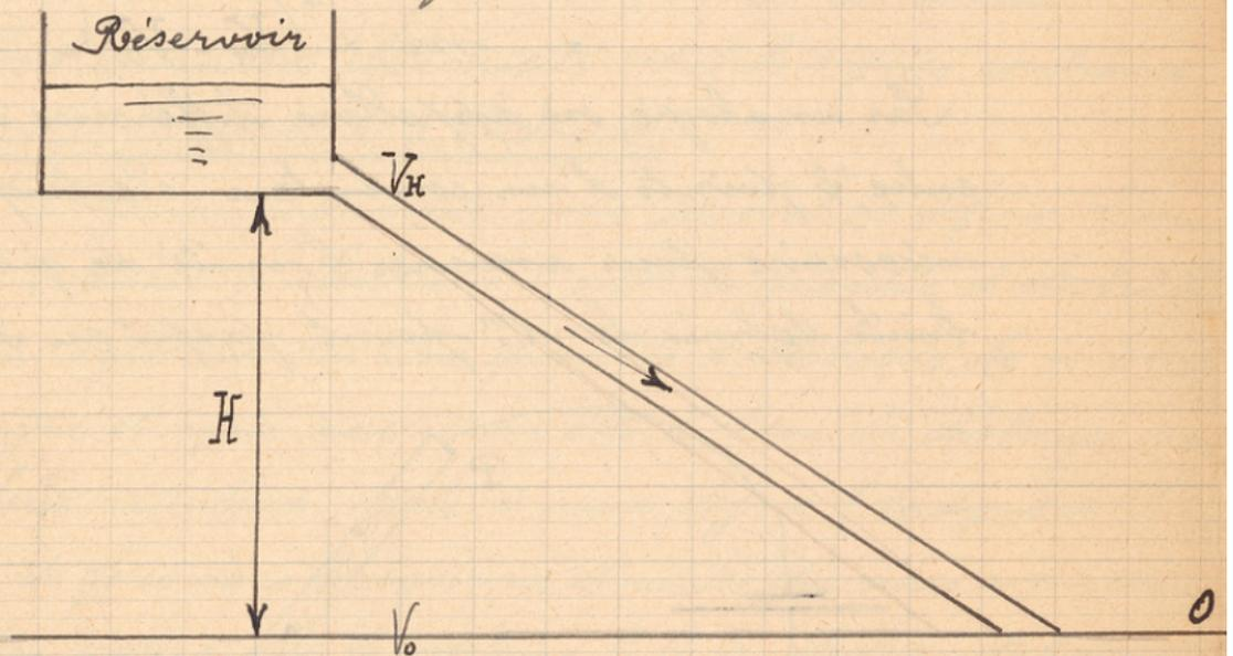
Si nous considérons un réservoir et une conduite descendante, l'eau s'écoule dans la conduite, on dit qu'il y a un courant d'eau.
