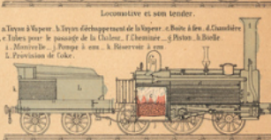
Coupe intérieure d'une Locomotive.
