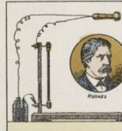
Heureusement, la découverte du **microphone** due à Hughes, vint fournir un transmetteur bien plus puissant ; de sorte qu'on appelle aujourd'hui téléphone un dispositif dans lequel sont combinés le transmetteur microphonique de Hughes et le récepteur magnétique de Bell ou, plus exactement, des dérivés de ces appareils.
