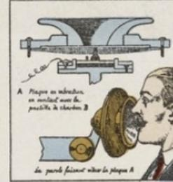
Tout son produit devant la membrane la fait vibrer et celle-ci, en faisant varier par ses oscillations le champ magnétique de l'aimant, développe dans cet aimant des courants induits transmis par la ligne à l'autre appareil.
