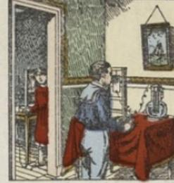
Imaginez que l'on parle près d'une plaque mobile assez flexible pour ne perdre aucune des vibrations produites par la voix, que cette plaque équilibre et interrompe successivement la communication avec une pile ; vous pourrez avoir à distance une autre plaque qui exécutera simultanément les mêmes vibrations.
