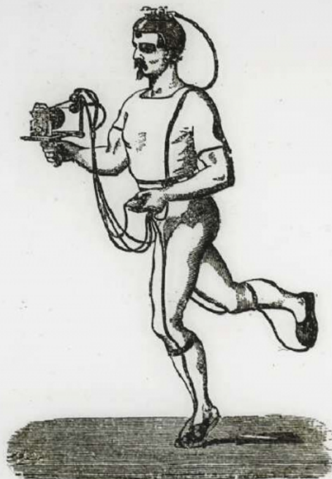
Coureur muni de chaussures exploratrices et portant l'appareil inscripteur du rythme de son allure (Marey).
