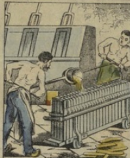
Les lingots d'or sont alors FONDUS dans des creusets de graphite; on y ajoute un dixième de cuivre, c'est-à-dire 1 kil. de cuivre contre 9 kil. d'or pur. Lorsque le métal est entièrement fondu, on le coule dans une lingotière à plusieurs trous en forme de barres verticales ayant 6 mm. d'épaisseur.
