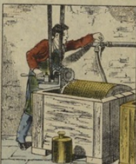
Après vérification, les louis d'or, non frappés encore, sont soumis au DÉCAPAGE, opération destinée à les nettoyer et à les rendre brillants. A cet effet, on les place dans un tonneau rempli d'un acide qui dissout les pellicules noires d'oxyde de cuivre dont ils sont couverts.
