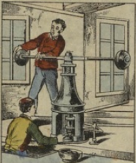
En 1600, Nicolas Briot inventa le BALANCIER. Ce fut un progrès réel, mais la fabrication était forcément bien lente, puisqu'il fallait à l'ouvrier le temps de détourner la branche du balancier pour reprendre un nouvel élan et frapper une nouvelle pièce.
