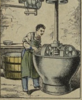
Les louis d'or, une fois frappés et finis, sont mis en sacs de 6 kilos pour être remis à ceux qui ont donné les lingots à monnayer. Toutes les poussières et tous les résidus des ateliers sont soigneusement balayés et puis broyés avec une meule pour être nettoyés et enfin refondus. On retrouve de cette façon par an plus de 50,000 fr. d'or.
