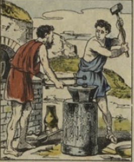
Il est intéressant de voir comment les peuples s'y sont pris, depuis l'antiquité jusqu'à nos jours, pour frapper leurs monnaies. Les anciens fixaient leurs COINS sur les deux branches d'une tenaille et frappaient leurs monnaies à l'aide d'un lourd marteau.
