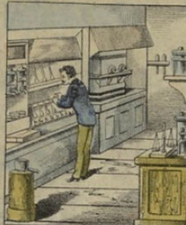
A cet effet, chaque lingot est soumis à l'ESSAYAGE dans un laboratoire spécial, où des chimistes l'analysent et reconnaissent sa valeur exacte qui dépend de sa pureté. Chaque kilogramme d'or pur vaut environ 2440 francs.
