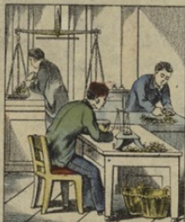
Le louis d'or ne porte encore à ce moment aucune marque ou frappé à sa surface. Avant de l'envoyer au MONNAIEUR on le vérifie au par un à la balance qu'on appelle TRÉBUCHET. Si par hasard un louis pèse trop ou trop peu, il est rejeté et renvoyé à la fonte.
