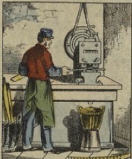
Une fois laminées, les barres d'or sont portées sous un puissant emporte-pièces qui découpe les FLANS destinés à être frappés, juste à la dimension qu'ils doivent avoir. La barre sort de ce DÉCOUPEUR toute perforée de trous dont chacun a donné naissance à un LOUIS D'OR.
