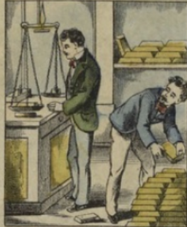
L'or est vendu aux banquiers qui le font fondre en lingots. Ces lingots d'or sont portés à la Monnaie pour y être transformés en pièces: on PÈSE d'abord les lingots pour connaître leur poids exact; puis, il importe de savoir si ces lingots sont d'or pur ou d'or plus ou moins mélangé d'alliage.
