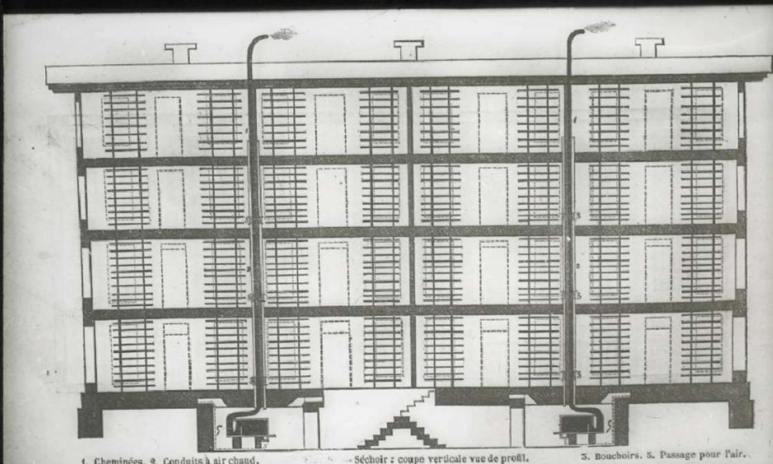
1. Cheminées. 2. Conduits à air chaud. 3. Séchoir : coupe verticale vue de profil. 4. Bouchoirs. 5. Passage pour l'air.
