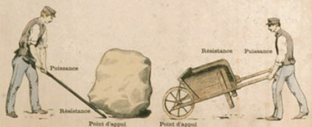
Leviers du 2 e genre: Résistance entre le point d'appui et la puissance.
