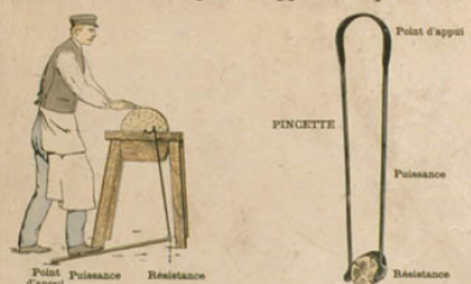
Leviers du 3 e genre: Puissance entre le point d'appui et la résistance.
