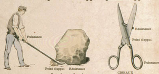
Leviers du 1 er genre: Point d'appui entre la puissance et la résistance.
