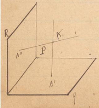
Un point est déterminé par ses projections sur 2 plans qui se coupent. Soit  $A'$  la projection d'un point sur un plan  $PQ$ ,  $A''$  sa projection sur un plan  $PR$ . Au point  $A'$  dans le plan  $PQ$  j'éleve une perp.; au point  $A''$  j'éleve de même dans le plan  $PR$  une perp.; ces 2 perp. se rencontrent en  $A$  qui est le point
