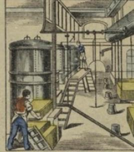
Cette viande liquéfiée passe ensuite dans des appareils à clarifier qui éliminent la graisse, l'albumine et les autres parties qui empêcheraient la conservation de l'EXTRAIT. Il en sort un sirop clair, véritable jus de viande que des pompes à air refoulent dans des réservoirs à évaporer d'une contenance d'environ 5000 litres.
