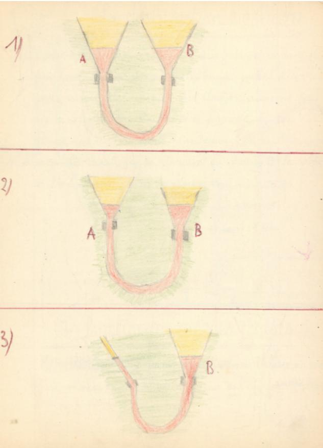
2) Quand on abaisse l'un des entonnoirs, la surface de l'eau monte dans cet entonnoir et descend dans celui qui n'a pas bougé. Bientôt, la surface s'établit au même niveau dans les deux entonnoirs.
