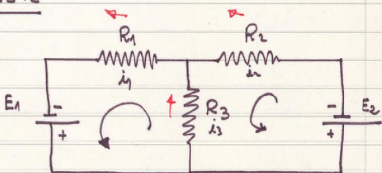
$$\text{on a: } \begin{cases} E_1 = R_3 i_3 + R_1 i_1 \\ -E_2 = R_2 i_2 + R_3 i_3 \end{cases}$$
