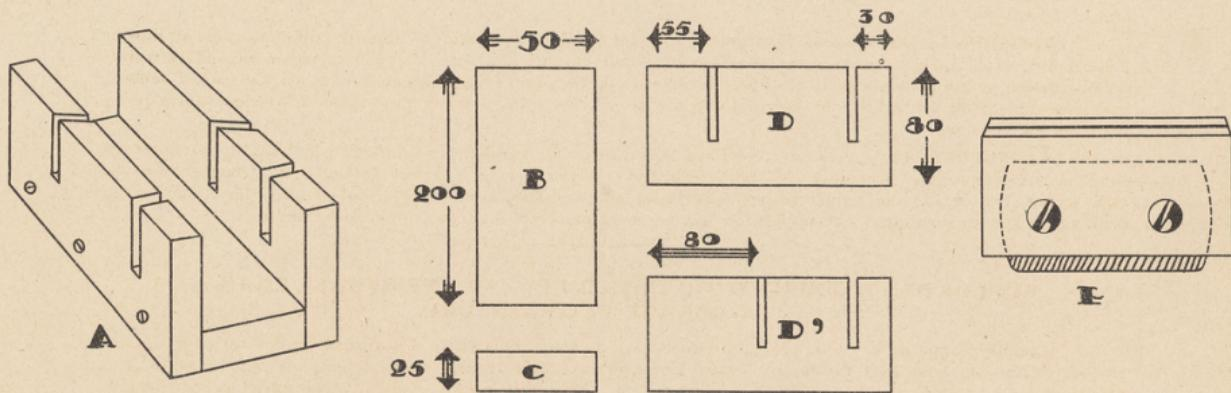
Les côtés DD' sont vissés solidement dans l'épaisseur du fond B. Les encoches "guide scie" descendent jusqu'au ras du fond. Pour pouvoir scier les pièces complètement sans entamer le fond, on intercale une plaquette de bois entre la pièce et le fond.
