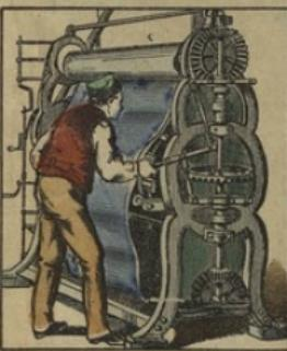
Quand le drap est teint, on le passe à la Laveuse, machine composée de plusieurs tambours renversés se frictionnent. Les pointes acérées des chardons tirent les poils de la laine et forment sur le drap une surface moelleuse.
