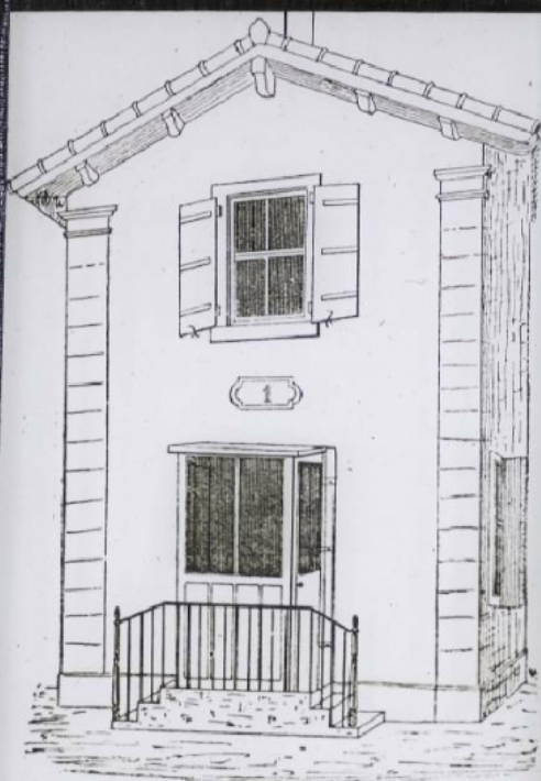
Fig. LIV. — Maison de cantonnier protégée contre les moustiques. Les fenêtres sont garnies de toile métallique; en avant de la porte d'entrée est un tambour en toile métallique; la cheminée est garnie également.
