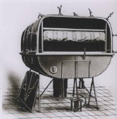
AUTOMOBILE SANITAIRE DE DION-BOUTON GONIN (L'étoffe tirée hors de son bureau a été recouverte sur ses rails. — Elle est prête à fonctionner)
