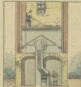
On procède alors à la **dessiccation** ou **torréfaction**. On dessèche à l'air chaud pendant trois jours au moyen de **fourrilles**, appareils comprenant un foyer et une surface de dessiccation constituée par une toile métallique. Le malt torréfié a subi une sorte de torréfaction et renferme moins d'amidon et plus de sucre que le grain d'orge.
