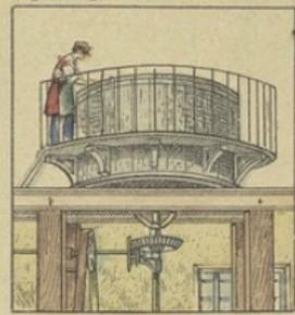
La **trémpe** par infusion se fait dans un récipient nommé **cuve-matière**. L'eau à 40° est versée sur le malt puis on fait arriver de l'eau à 55°. Le brassage est suivi d'un repos d'une heure. Le mout est décanté puis on répète souvent une infusion à 75° et une à 80°. Le résidu insoluble est appelé **dèche**.
