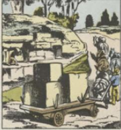
Les pierres à bâtir sont très abondantes en France et sont exploitées dans de nombreuses carrières. Les pierres de taille sont celles qui, formant de gros blocs et susceptibles d'un certain poli, sont destinées à rester apparentes dans les constructions. Les moellons au contraire sont des pierres de petites dimensions et d'un grain grossier qu'on emploie dans la maçonnerie.
