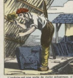
L'ardoise est une sorte de roche schisteuse, d'un gris bleuâtre plus ou moins foncé, qui présente la particularité de se diviser aisément par choc en feuilles minces. Elle est employée à de multiples usages, dont le principal, en construction, est de revêtir la toiture pour la couverture des maisons. L'ardoise se juge bonne quand à la fois elle est de teinte foncée, pesante, dure et qu'elle ne boit pas l'eau. Les principales ardoiseries en France se trouvent près d'Angers.
