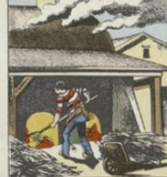
De même que la pierre à chaux, la pierre à plâtre est cuite dans des fours. Cette calcination, ou la trassification en plâtre, le rend facilement affranchable. On la réduit alors en poudre par bruyage et on tamise encore cette poudre pour éliminer les éléments étrangers; le plâtre ainsi obtenu est en possession impalpable. En cet état, comme il est très avide d'eau, il faut avoir soin de le préserver de l'humidité.
