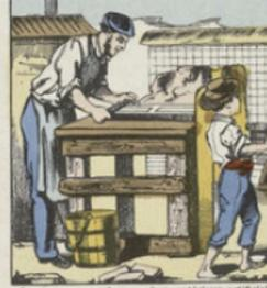
Les briques sont les premiers matériaux artificiels que l'homme ait fabriqués. Primitivement, on employait des briques simplement séchées au soleil et ce n'est que beaucoup plus tard que la cuisson au four fut appliquée. La pâte qui sert à fabriquer les briques ou les tuiles est obtenue en mélangeant et pétrissant ensemble de l'argile commune et du sable.
