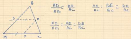
$\frac{AD}{AB} = \frac{AE}{AC}$  ;  $\frac{AE}{AC} = \frac{BE}{BC} = \frac{DE}{BC}$
