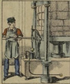
La PRESSE HYDRAULIQUE, dont l'action est si puissante, est due à notre grand Pascal en 1642. Son principe est l'incompressibilité de l'eau. Elle permet d'obtenir des pressions considérables ou de soulever des poids énormes comme, par exemple, le tablier en fer d'un pont métallique, pour le poser sur ses piles.
