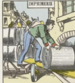
Ces grosses bobines de papier continu sont envoyées aux imprimeries de journaux. Des camions les amènent et on les fait glisser sur des planches inclinées dans les caves ou sous-sols des imprimeries.
