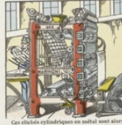
Ces clichés cylindriques en métal sont alors fixés sur la machine à imprimer et il n'y a plus désormais, après une machine à imprimer, une pile qui assurera la pression uniforme sur la machine, toujours un peu inégale des clichés, qu'à la laisser marcher toute seule. Le cylindre de papier s'engage sous les rouleaux, s'imprime à raison de 30,000 à l'heure et se découpe tout seul en journal.
