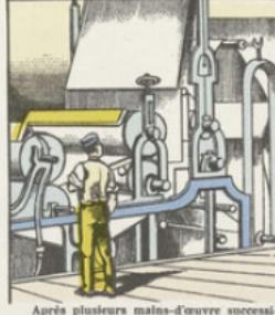
Après plusieurs mains-d'œuvre successives, la pâte est transformée par une machine spéciale en papier sans fin qui s'enroule sous forme de bobine, sans jamais s'arrêter ni jour ni nuit.
