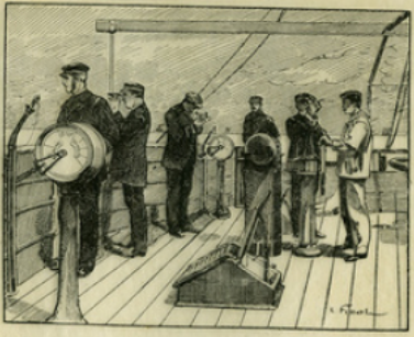
Fig. 8. — Au moyen de la montre de précision (chronomètre), de la boussole et du sextant (appareil servant à mesurer les angles en observant le soleil), les marins chaque jour déterminent exactement en pleine mer le point du globe où ils sont (longitude et latitude).
