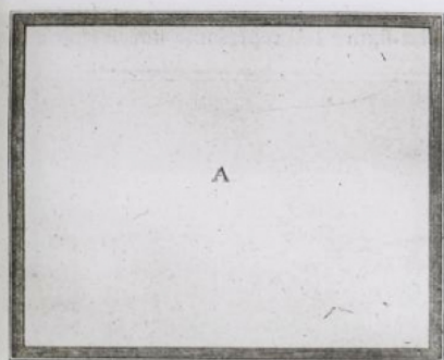
Fig. 111. — Châssis, ou frisquette , que le pousseur pose sur la forme, au moment de puiser la pâte dans la cuve.
