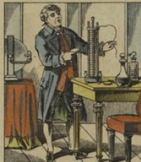
Sur cette base, il créa un instrument composé de rondelles de cuivre et de rondelles de zinc séparées par des rondelles de drap mouillé, reproduisant artificiellement les circonstances du phénomène de Galvani. C'est ce qu'on nomme la PILE de VOLTA, l'une des plus immenses et plus importantes inventions de l'humanité. (Décembre 1790.)
