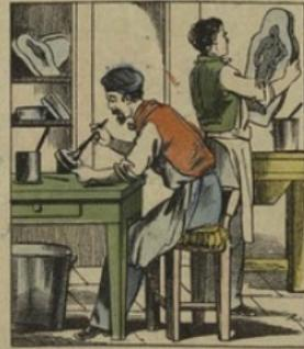
Ce MOULE en gutta est alors enduit au pinceau d'une couche de plombagine: (c'est la croix au crayon de Jacobi.) Cette plombagine rend les moules conducteurs du courant voltaïque, c'est-à-dire leur donne l'adhésité qui leur est nécessaire pour que le cuivre du bain (si c'est sur le cuivre qu'on opère) vienne s'y déposer.
