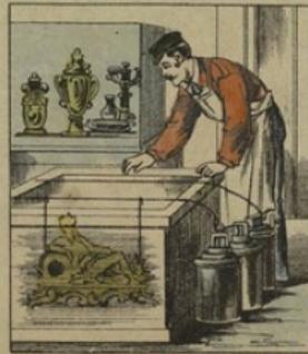
Les moules bien enduits de plombagine sont alors descendus dans le bain et accrochés aux tringles métalliques à travers lesquelles circule le courant voltaïque. Aussitôt le bain métallique se décompose, et le métal se dépose sur les moules en en prenant tous les reliefs avec une fidélité infinie.
