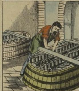
Grâce à elle, on peut cuivre, dorer, argentier, nicker, etc. tout objet, vase, statue, médaille, moule quelconque, bois, etc. qu'on dépose dans le bain métallique, ou bien le reproduire à l'infini. C'est par la GALVANOPLASTIE qu'on a recouvert d'une épaisse couche de bronze les fontaines et les réverbères en fonte de la ville de Paris.
