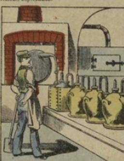
C'est avec le SEL que le célèbre français Leblanc, en 1791, produisit la soude artificielle, ce produit si précieux employé aujourd'hui par tant d'industries. Ensuite, le SEL a un courant d'acide sulfurique, on donne naissance à des sulfates de soude qui, calciné avec de la craie et du charbon, produisent la SOUDE.
