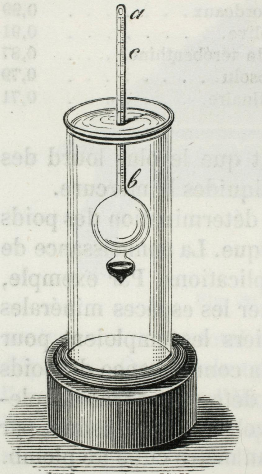
Fig. 83. — Aréomètre
