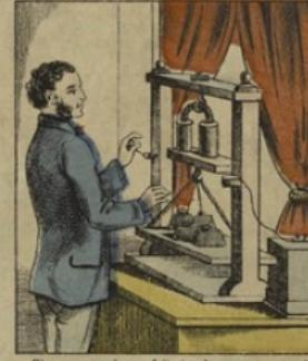
Si, par exemple, on fait circuler un courant électrique autour d'un cercle de fer doux, courbé en forme de fer à cheval, et se transmettant ainsi l'électricité, et peut attirer une grosse barre de fer. Si le courant cesse, l'alimentation cesse également. On peut ainsi attirer et défaire le fer un nombre infini de fois dans une seconde.
