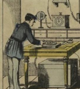
On comprend alors facilement que, en renouvelant successivement. Par le moyen d'un courant électrique, l'aimant ainsi placé à Marseille, et, sans qu'il se fasse, il la transforme en aimant, et cet aimant fait avancer l'aiguille d'un pas sur son cadran. L'emploi du télégraphe n'a plus qu'à noter alors les lettres de l'alphabet sur lesquelles s'arrête l'aiguille.
