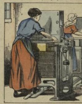
Une machine ingénieuse couche tous ces petits bouts de bois par rangs étages dans une caisse sans fond, où ils sont solidement maintenus et séparés par des tranches parallèles par de petites saletés. C'est ce qu'on appelle la PRESSE. Chaque PRESSE contient 5.500 allumettes.
