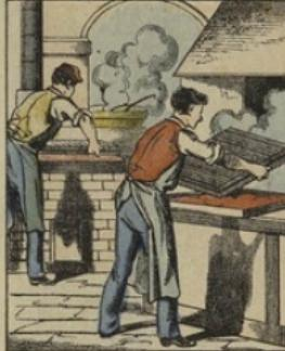
Cette PRESSE est alors plongée dans un bain de soufre liquide, puis passée sur une plaque recouverte d'une épaisse couche de pâte chimique phosphorée. Les 5.500 allumettes se trouvent ainsi soufrées puis phosphorées d'un seul coup.
