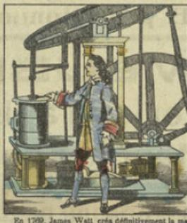
En 1765, James Watt créa définitivement la machine à vapeur telle que nous la connaissons. Au lieu d'employer le vide et la pression de l'air, il employa la vapeur comme moteur sur les DEUX FACES du piston : il inventa le condenseur, la pompe à air, le régulateur, le parallélogramme articulé, etc. etc.
