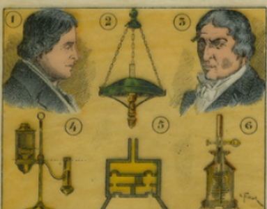
Fig. 7. — 1, Portrait de Carcel; 2, Lampe d'Argand; 3, Portrait d'Argand; 4, Lampe de Quinquet (coupe); 5, Pompe de la lampe Carcel; 6, Lampe modérateur (coupe).
