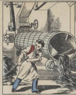
I<sup>e</sup> TABAC À PRISER. Les tabacs destinés à cette fabrication sont mélangés et mouillés avec de l'eau additionnée de sel dans un MOUILLEUR MÉCANIQUE, opération qui a pour but d'augmenter leur goût et leur arôme. Puis, ces feuilles sont hachées menu par des HACHOIRS spéciaux.
