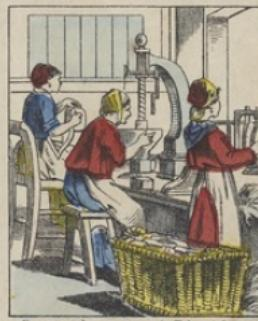
En sortant de ces masses, le Tabac à fumer est porté aux APPAREILS DE PAQUETAGE qui le débiteront en paquets de 40, 50, de 100, de 500 gr. Cette opération se fait mécaniquement, c'est l'ouvrière n'a plus qu'à fermer le paquet et à coller la bande de la régie.
