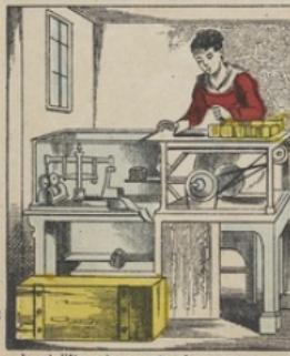
Avant d'être mis en vente, chaque paquet passe sur la MACHINE À PESEN, admirable et intelligent petit appareil dû à l'invention de l'ingénieur Darignies. Tout paquet pesant TROP ou TROP PEU est rejeté mécaniquement par l'appareil et retourne subir un nouveau paquetage.
