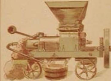
ESTRUJADORA Y PRENSADORA CONTINUA
