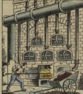
Le gaz est produit par la carbonisation de la houille qu'on charge dans des cornues de tarde que l'on fait chauffer au rouge écarlate. La houille distillée, le gaz s'échappe dans des tuyaux et dans les cornues reste le coke qui est un combustible précieux.
