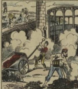
Le coke, retiré des cornues à gaz, est porté sur des wagonnets à un endroit de l'usine où on l'éteint sous des jets d'eau froide. Cassé ensuite en morceaux plus ou moins gros, il est vendu aux ménagères. La vente du coke paie à elle seule la fabrication du gaz.
