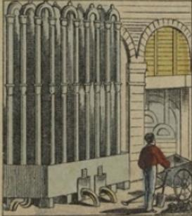
Le gaz qui sort des cornues est impur et mêlange des goudrons, d'acides, de produits infects, etc. Il faut le purifier pour qu'il puisse être utilisé pour éclairer. A cet effet, on le fait passer dans des tubes en U, appelés jeux d'orgue, remplis d'eau. Le gaz s'y lave une première fois.
