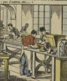
Le Cacao est alors pesé avec même quantité de sucre et versé dans un instrument composé d'une cavette en grès et de 3 roues en bois de pierre qui l'assaisson, les écrasent et en font un mélange uniforme. De là, on les porte dans les laminaires à 3 cylindres en granit tournés au diamant, qui en font une pâte fine et homogène.
