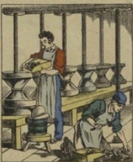
Le graphite est un mélange naturel de charbon et de fer (ou carbure de fer) qui se rencontre par masses dans les terrains schisteux. On le casse en morceaux et on le pulvérise en poussière impalpable dans des moulins en acier fondé.
