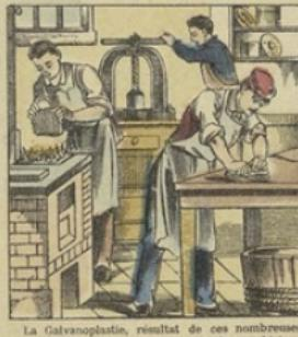
La Galvanoplastie, résultant de ces nombreuses expériences, est donc l'art de reproduire un objet ou simplement de le recouvrir d'une couche métallique. Pour reproduire un objet, il faut d'abord en prendre un moule représentant les moindres détails du modèle. La **gutta-percha**, qui se prête très bien à l'obtention d'un creux parfait, est la plus généralement employée.
