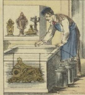
Les moules, bien enduits de pléomagnie, sont alors descendus dans le bain et accrochés à des tringles métalliques reliées au pôle négatif de la pile. On fait passer le courant et quand on juge que l'épaisseur du dépôt est suffisante, on retire le moule et on détache l'empreinte obtenue.
