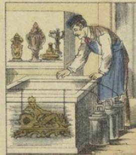
Les muscles, bien enduits de plombagine, sont alors descendus dans le bain et accrochés à des triangles métalliques reliés au pôle négatif de la pile. On fait passer le courant et quand on juge que l'épaisseur du dépôt est suffisante, on retire le moule et on détache l'empreinte obtenue.
