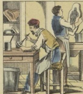
Lorsqu'on a le moule de guta, on le recouvre avec un pinceau d'une légère couche de plombagine dissoute à le rendre conducteur du courant. La plombagine s'applique avec un grand soin sur les formes les plus délicates sans amerer l'engorgement des détails ni la déformation du modèle.
