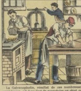
La Galvanoplastie, résultat de ces nombreuses expériences, est donc l'art de reproduire un objet ou simplement de le recouvrir d'une couche métallique. Pour reproduire un objet, il faut d'abord en prendre un moule représentant les moindres détails du modèle. La guta-percha, qui se prête très bien à l'obtention d'un creux parfait, est le plus généralement employé.
