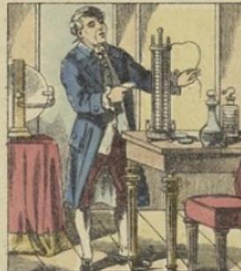
Des recherches le conduisirent, par d'habiles déductions, à la découverte de la pile qui porte son nom. La **Pile de Volta** se compose de disques de cuivre et de disques de zinc, isolés l'un de l'autre par une rondelle de drap ou de carton trempée dans l'eau acidulée, et empliés entre trois colonnettes de verre.
