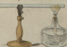
En chauffant l'extrémité de la tige de verre, la cire mise à l'autre extrémité ne fond pas.
