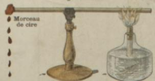
En chauffant l'extrémité de la tige de cuivre, au bout de quelque temps la cire mise à l'autre extrémité fond.
