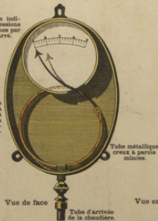
MANOMÈTRE servant à mesurer la pression de la vapeur.
