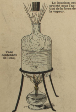
La force d'expansion de la vapeur augmente en chauffant.
