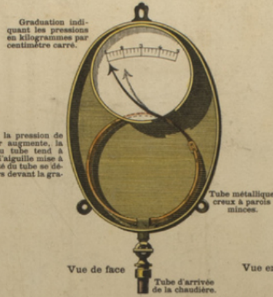
MANOMÈTRE servant à mesurer la pression de la vapeur.
